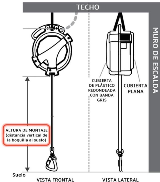
Utilice la siguiente tabla (Tabla 1) para determinar la altura límite de montaje del dispositivo. **Si su(s) dispositivo(s) está(n) montado(s) por debajo de esta altura, proceda al paso #3.** Si está montado por encima, puede continuar usándolo a esa altura o más, según el manual de operación del dispositivo.
